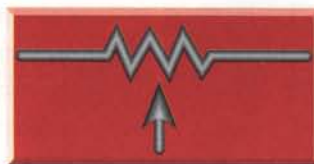
Figura 6.11. Símbolo de los potenciómetros
